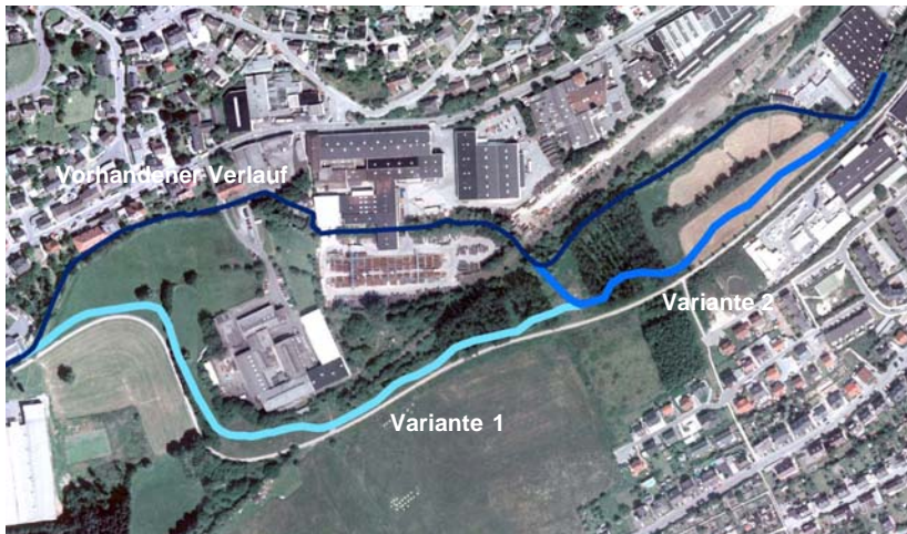
Varianten zur Verlegung der Else
